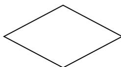
блок «решение», определяющий последующие шаги выполнения алгоритма в зависимости от выполнения условия (допускает любое количество входов, но только два выхода - да и нет).
